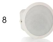
Laekõlar koaksiaal suure võimsusega, 4", 40W (8Ω) vōimsusega, 100V/20W-12W-8W-4W-2W-8Ω, 120-20000 Hz, 87 dB (1W/1m). Kiirkinnitus . Mõõdud Ø203 x 164 mm, plastkorpus, metall kuppel, aluminiium võre, valge (RAL9016).
