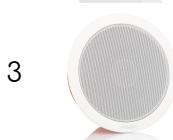
Laekõlar koaksiaal metaalist tuleohutu oranž korpusega metallist. 6", 100V/10W-5W-2.5W, 150-20000 Hz, 93 dB (1W/1m). Kiirkinnitus . keraamiline terminal kaitsemega are installed under the default. Mõõdud Ø200 x 101 mm, metall, valge (RAL9016).
