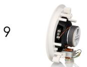
Laekõlar koaksiaal plastikust, 5", 100V/10W-5W-2.5W-1.25W, 90-20000 Hz, 88 dB (1W/1m). Kiirkinnitus . Mõõdud Ø190 x 70 mm, plastic, metall võre, valge (RAL9016).
